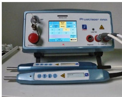
◀ Abb. 1: Laserpen 70 mW, 785 nm, cw Laser. Reimers & Janssen, Berlin
